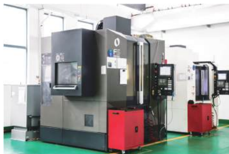
CNC加工中心 CNC Processing Centre
